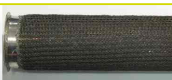
Hengeres kialakítású, acélorost-hálóval borított nemesacél égő Ellenáll a magas hőmérsékletnek Rövid lángot biztosít a tökéletes égés és a minimális Nox kibocsátás érdekében
