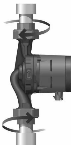
1. ábra ALPHAx beépítés
